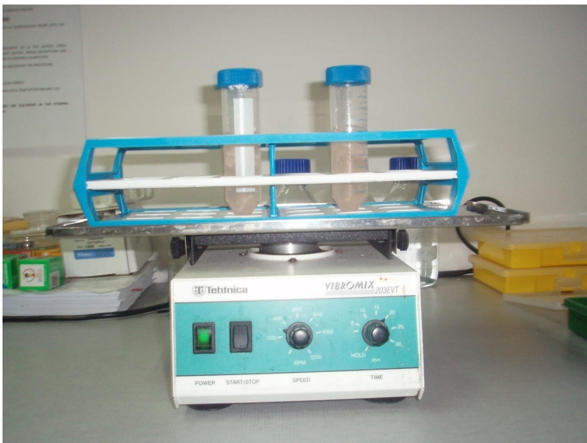
Slika 21: Spiraje fragmentov možganskega tkiva s fosfatnim pufrom. Zaradi boljšega izpiranja si velikokrat pomagamo s stresalnikom
