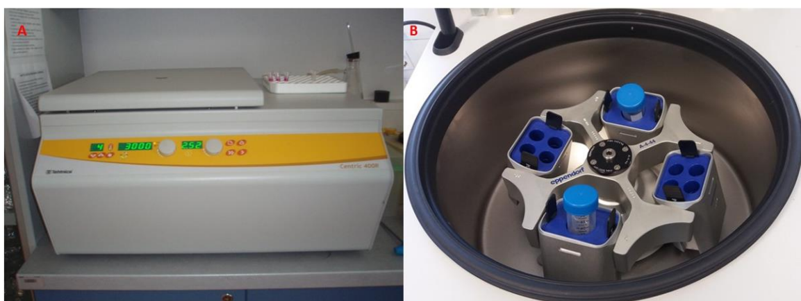
Slika 22: Centrifuga in centrifugirke s celično suspenzijo pred centrifugiranjem
