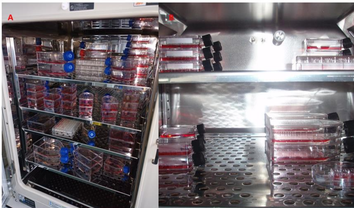
Slika 25: Inkubator za celične kulture (A) in stekleničke s celičnimi kulturami v inkubatorju (B). Celice rastejo v okolju z nadzorovano atmosfero pri 37 °C in 5 % CO 2
